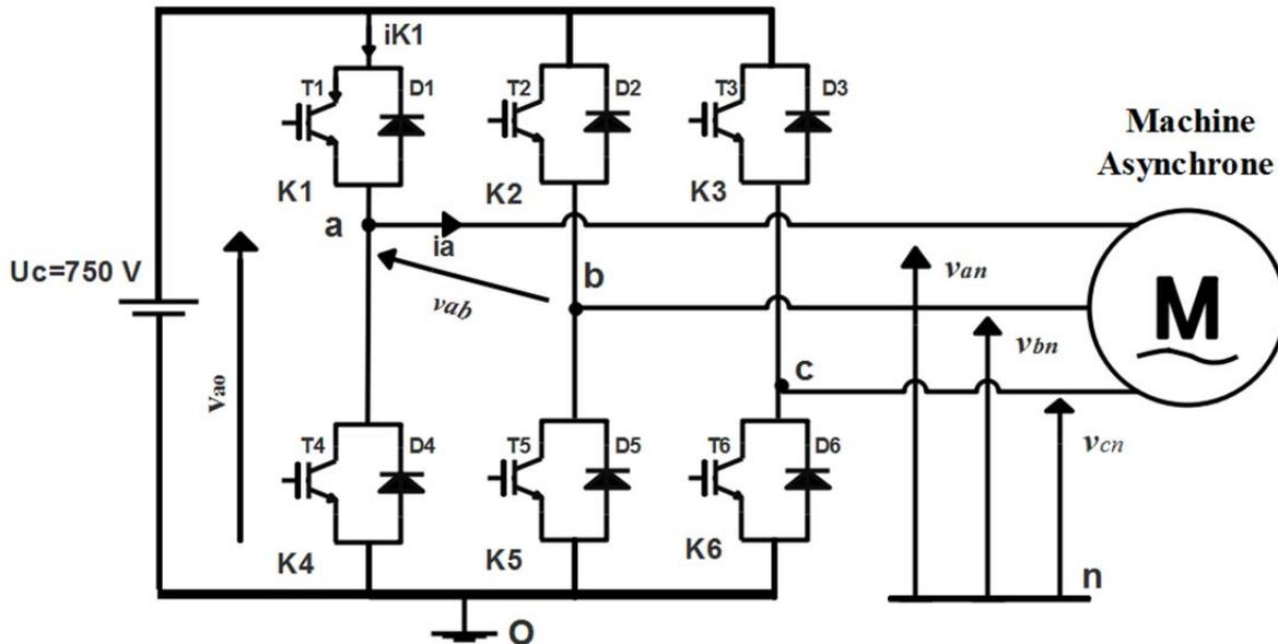
Figure 5 : Association machine-onduleur
