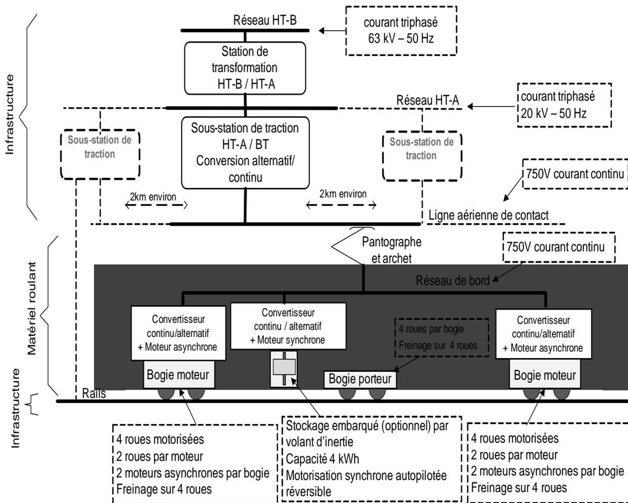
Figure 9 : Architecture générale d'une ligne de tramway
